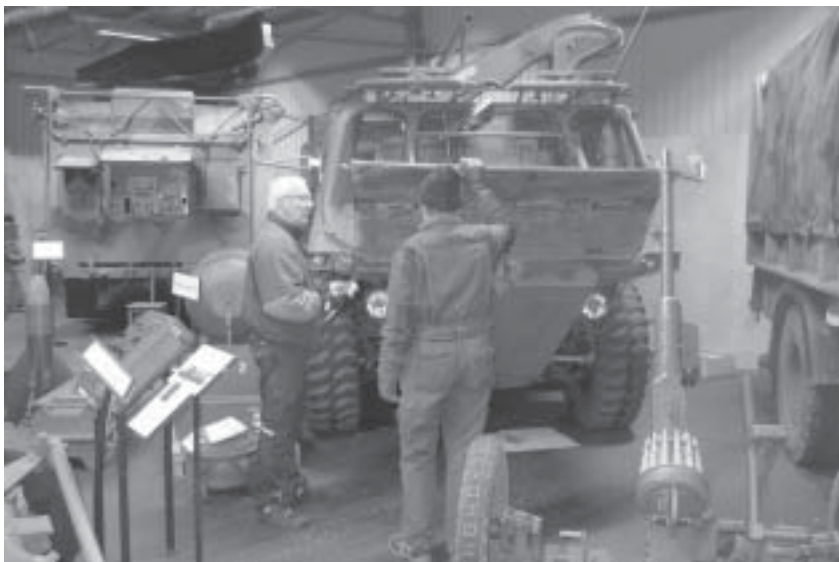
B-G Fransson och Hans Willebrand under arbete med att demontera "stänkbordet" för utbyte på Alvisen
