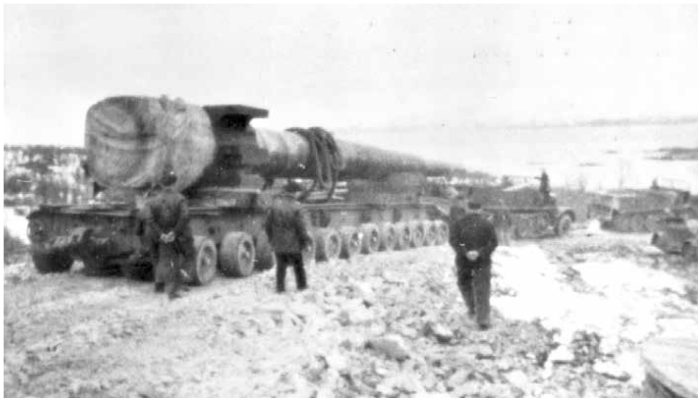
Eldröret på en av "Adolf-kanonerna" dras på en vagn upp till ställningen vid Trondenes. Soldater eller arbetare i förgrunden arbetar med transportfordonet "Gotha", med 12 axlar & 48 hjul, samt hjälpfordonen som assisterade vid framförkörning. Foto Okänd tysk soldat, Sør-Troms Museum
